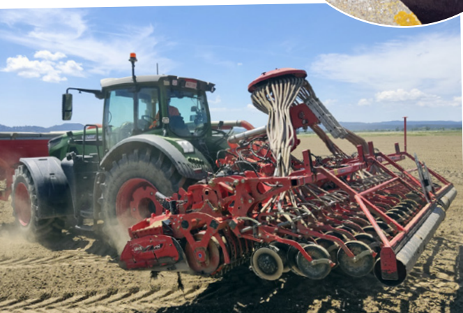
Un tractor proveït d'una sembradora en línia injecta llavors d'arròs al terreny un cop aquest ha estat llaurat: el cicle de l'arròs s'inicia aquí. Al detall, una séquia de reg al costat del mas Pla, a la zona més propera al mar.
